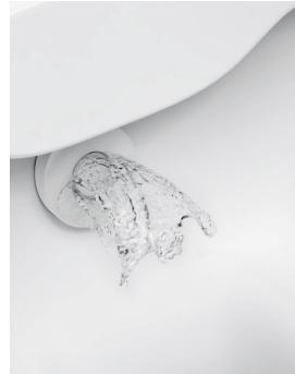
Den hygieniske flush renser Hele vannbærende systemet med vann oppvarmet til 70 grader. Systemet forteller brukeren når denne handlingen er nødvendig via fjernkontrollen og indikatorlyset på WC. Spyle kan også aktiveres individuelt og tar rundt 30 minutter å rengjøre.
