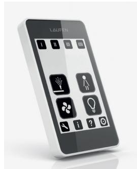
Fjernkontrollen med berøringskjerm gir mer informasjon og innstillingar for å støtte brukeren, slik at brukeren kan opprette opptil fire brukerprofiler for personlige tilpasninger.
